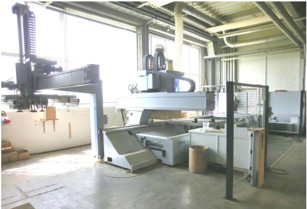
CNC-gesteuertes Bearbeitungszentrum in Kombination mit Verleimaggregat zur Fertigung von Werkstücken aus Holz oder holzähnlichen Werkstoffen.
