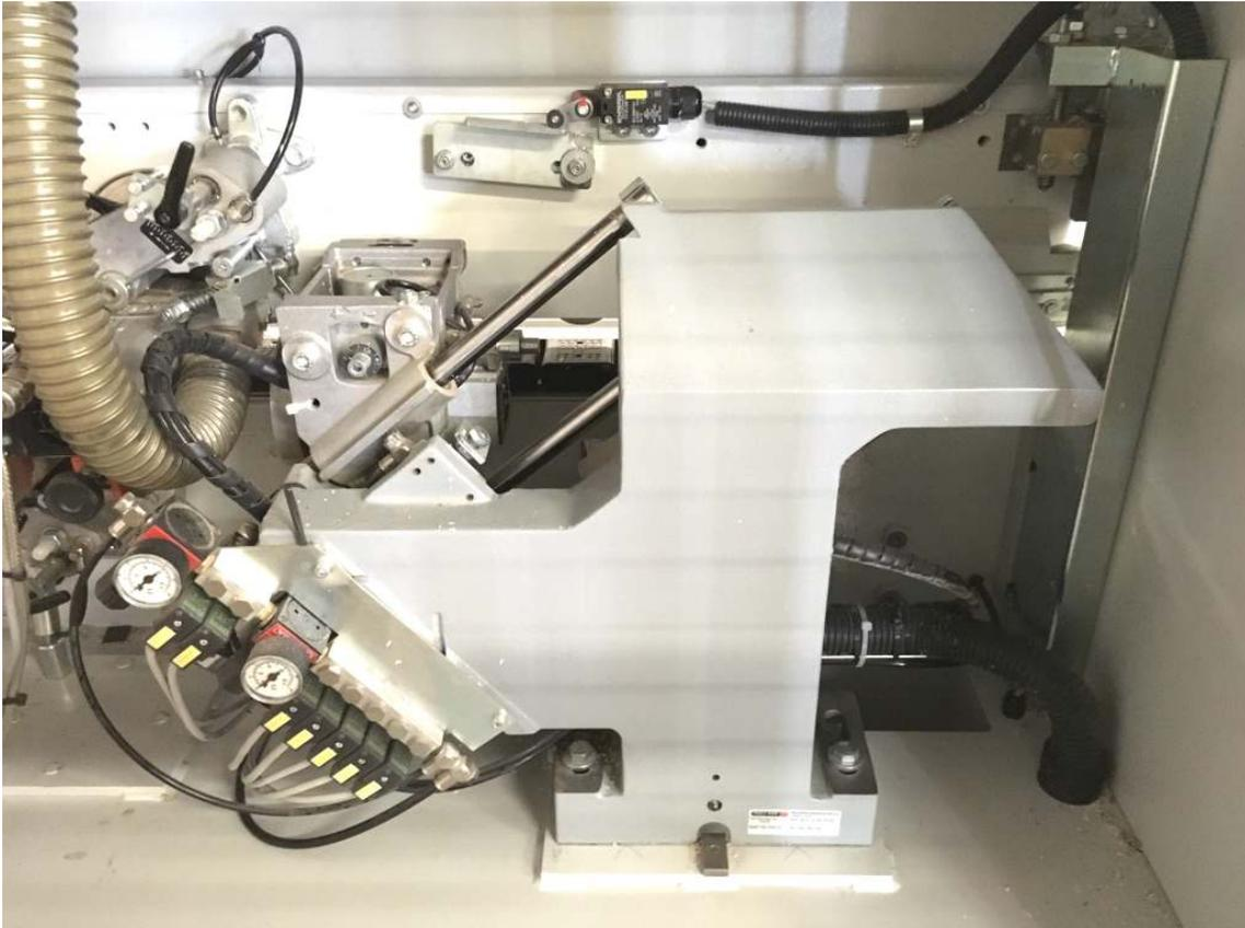
Multifunktionsaggregat 1942 M für Bündig-, Radius- und Fasefräsen
