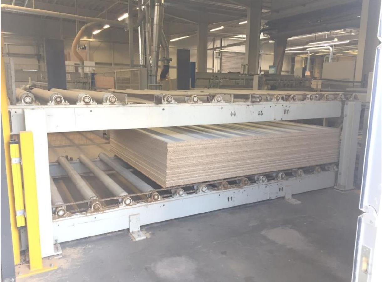
1 liegende Plattensäge mit Hubtischbeschickung panel saw with lift table feeding
